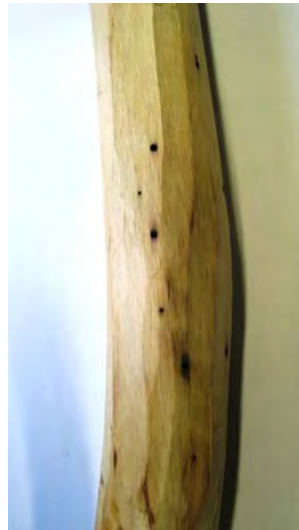
Gut sichtbar die ungleichen Einbohrlöcher
